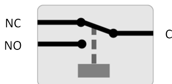
Funcționarea internă a releului programabil
