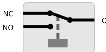
Funcționarea internă a releului programabil
